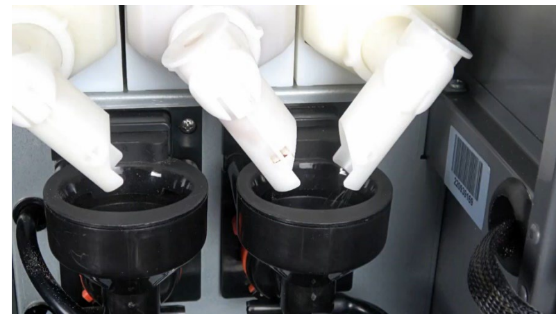
Высокоскоростные миксеры (20 000 оборотов в минуту)
