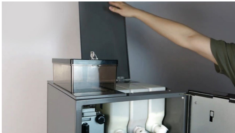
Загрузка растворимых ингредиентов через верхнюю крышку
