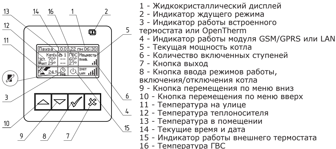
Рис.4 Расположение органов управления и индикации на передней панели
