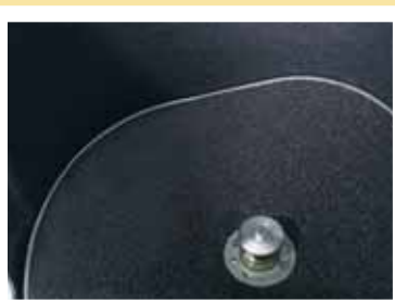
Абразивный диск и покрытие внутренних стенок рабочей камеры
