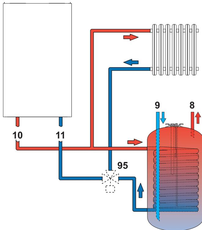
fig. 13 - Schéma de raccordement à un ballon extérieur
