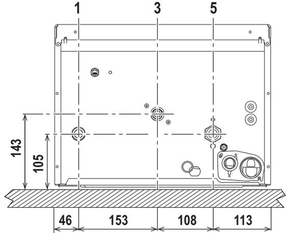
fig. 12 - Conexiones hidráulicas
