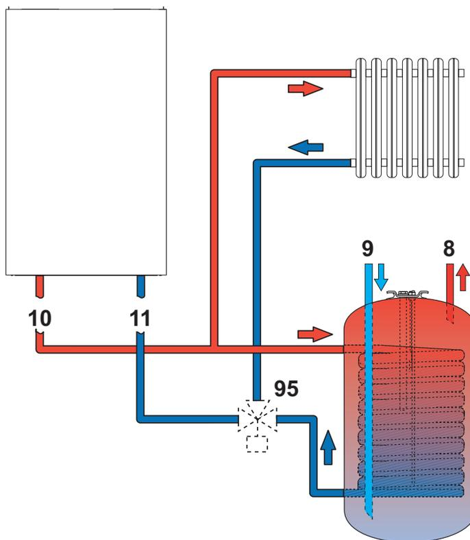
мал. 13 - Схема під'єднання до зовнішнього бойлера
