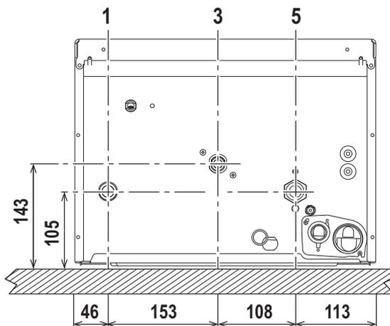
fig. 12 - Raccordements hydrauliques
