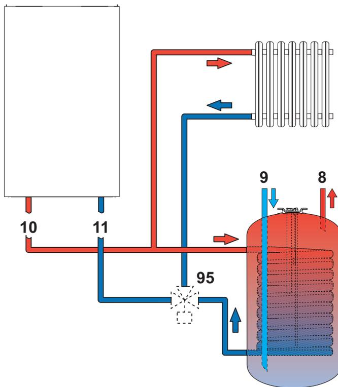
fig. 13 - Schema de racordare la un boiler extern
