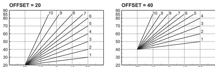
мал. 11 - Пиклад паралельного пересування компенсаційних кривих
