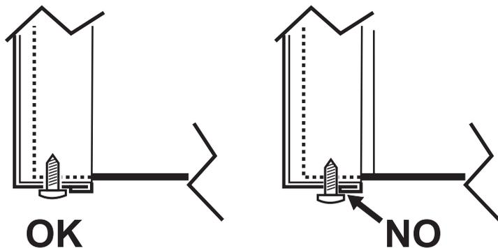
fig. 25 - Poziția corectă a panoului frontal
