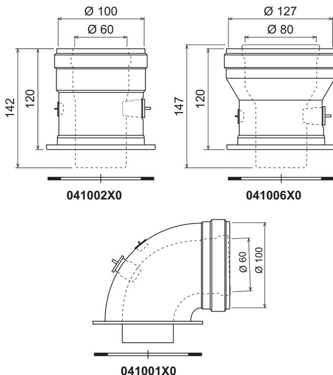
fig. 16 - Accesorios iniciales para conductos coaxiales
