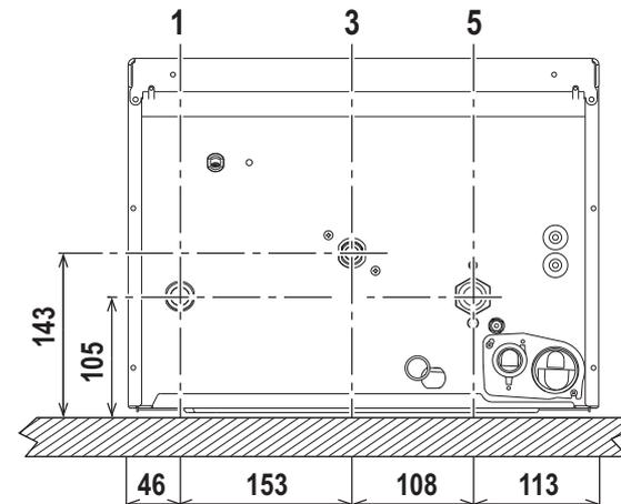
рис. 12 - Гидравлические соединения
