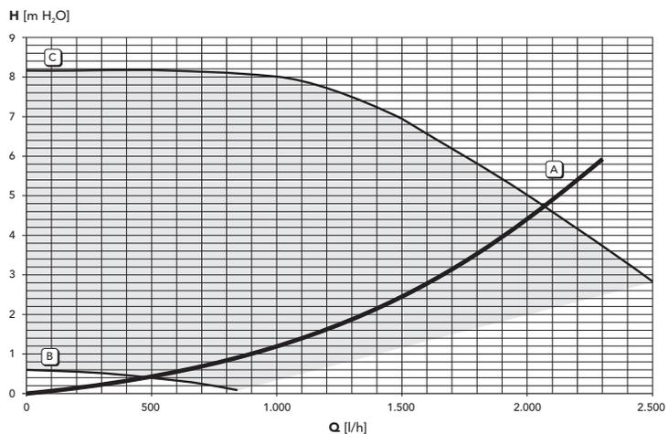
fig. 27 - Pertes de charge / pression circulateur
