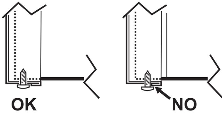
fig. 25 - Posición correcta del panel frontal
