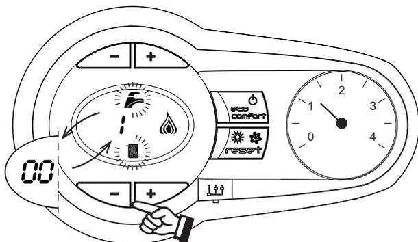
fig. 23 - Modalità TEST (potenza riscaldamento = 100%)
