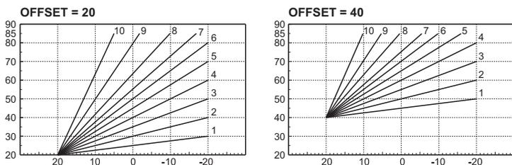
рис. 11 - Пример параллельного смещения компенсационных характеристик
