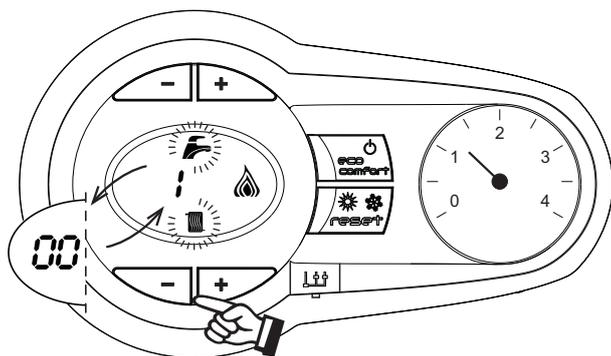
fig. 23 Modo TEST (potencia de calefacción = 100 %)
