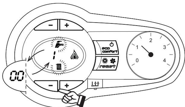
рис. 23 Режим TEST (мощность системы отопления = 100%)
