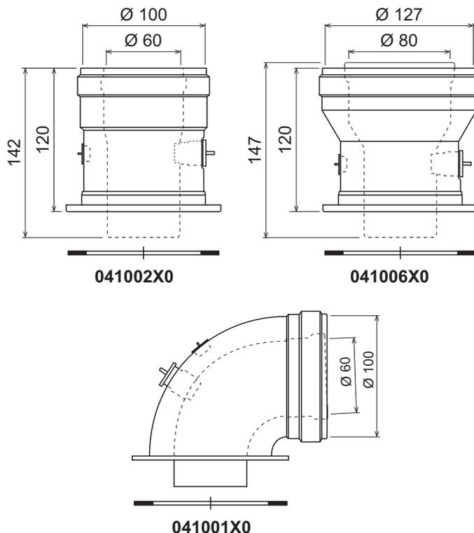
fig. 16 - Accesorii de pornire pentru conducte coaxiale
