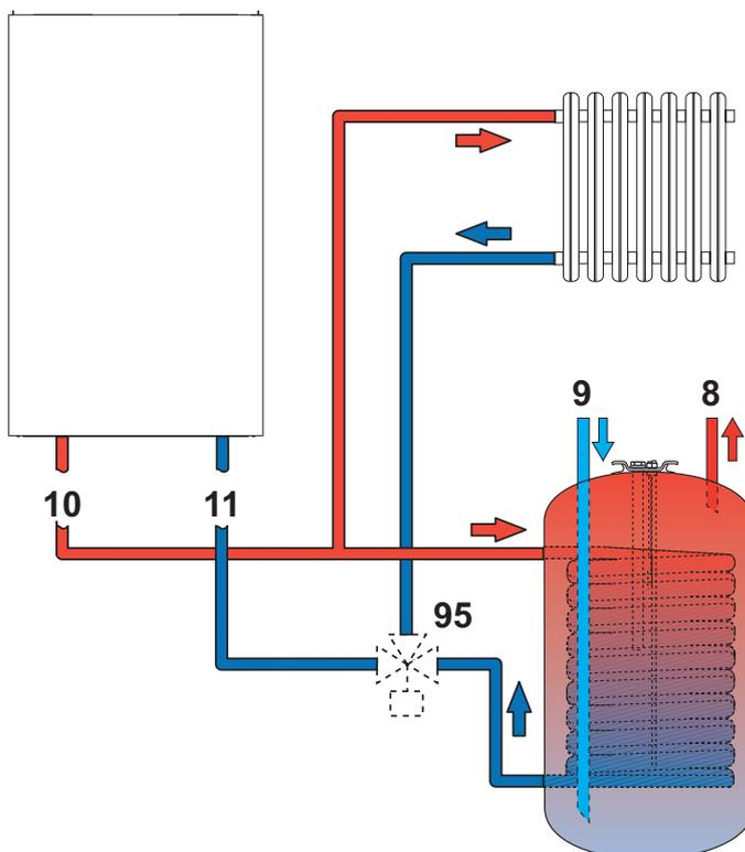
fig. 13 - Schema di collegamento ad un bollitore esterno
