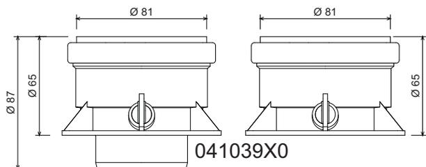
fig. 18 - Accesoriu de pornire pentru conducte separate
