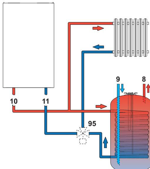
рис. 13 - Схема соединений с внешним бойлером
