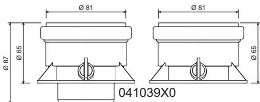
рис. 18 - Соединительный элемент для отдельных труб
