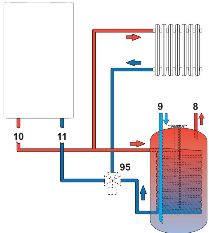
fig. 13 - Esquema de conexión a un acumulador externo
