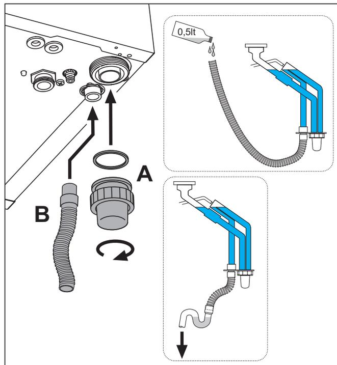
fig. 20 - Raccordement de l'évacuation de la condensation
