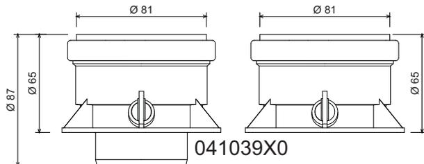
fig. 18 - Accessoire de départ pour conduits séparés
