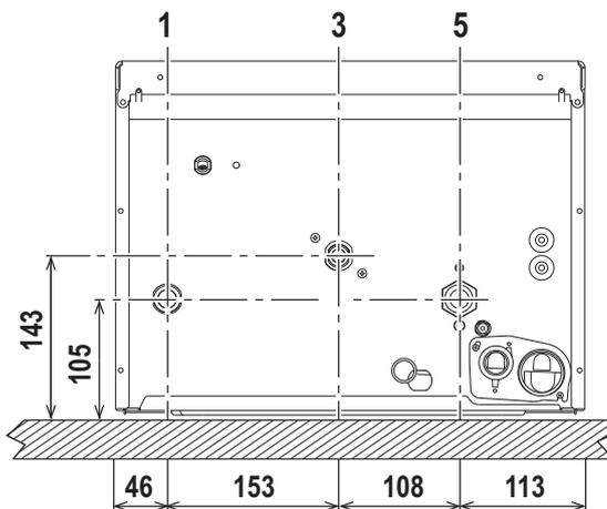
fig. 12 - Attacchi idraulici
