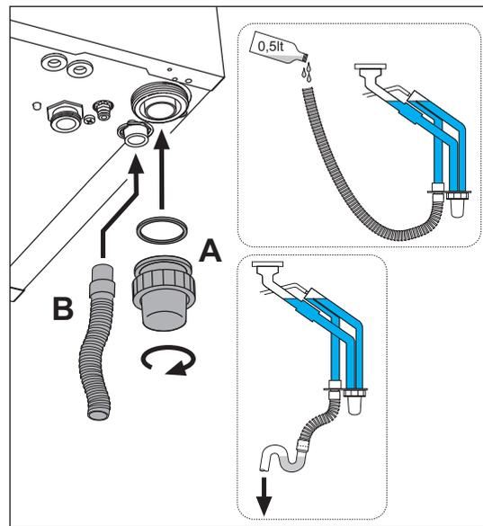
рис. 20 - Подсоединение трубы для слива конденсата
