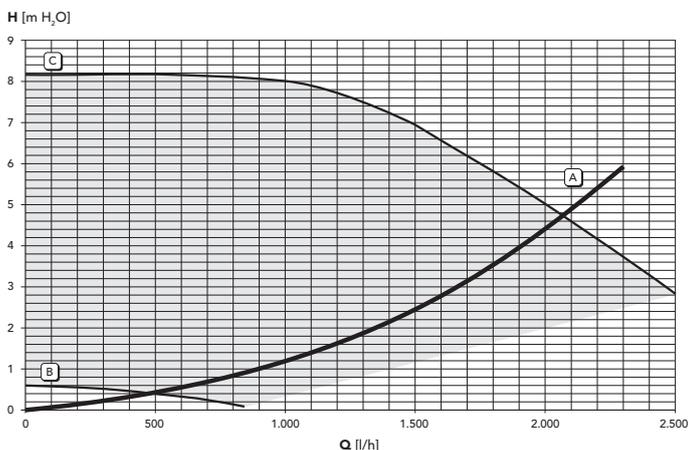
fig. 27 - Pérdidas de carga/altura manométrica circulador
