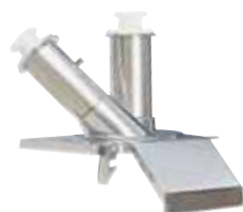
Воронка с прямой и наклонной трубками
