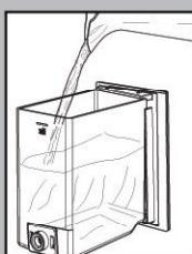
**⚠️ Предупреждение!** Снимите фильтр Intenza перед добавлением раствора для удаления накипи.
