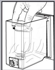
Извлеките фильтр для воды из упаковки, погрузите вертикально (с отверстиями, направленными вверх) в холодную воду и слегка придавите его стороны, чтобы удалить пузырьки воздуха.
