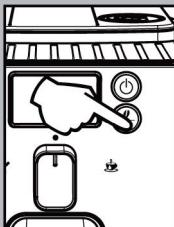
• Удерживая нажатой кнопку 6 секунд для перезагрузки прибора и отмены от сигнала очистки от накипи.
