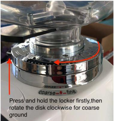
Перед вращением диска сначала нужно нажать на фиксатор и держатель, для диска 104 шага, поверните его в нужное положение, затем отпустите фиксатор.
