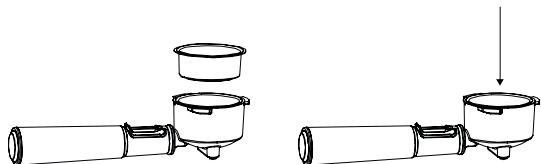
3. Насыпьте 2 ложки молотого кофе в фильтр для 2 чашек (13) до отметки MAX внутри фильтра и слегка спрессуйте с помощью темпера на обратной стороне мерной ложки (14), как показано на рисунке ниже. Удалите излишки кофе с краёв фильтра.
