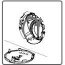
• закрывая крышку насоса, убедитесь в том, что части на внутренней стороне крышки совпадают с отверстиями на передней панели;
