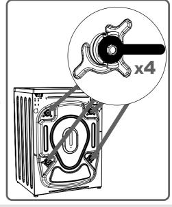
Вытащите предохранительные транспортировочные винты.
