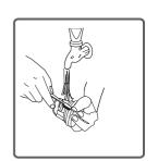
• после прочистки насоса закройте крышку фильтра, поворачивая по часовой стрелке;
